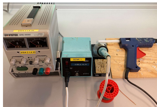
Figur 4: Felles teststasjon med strømforsyning, loddebolt og limpistol.
